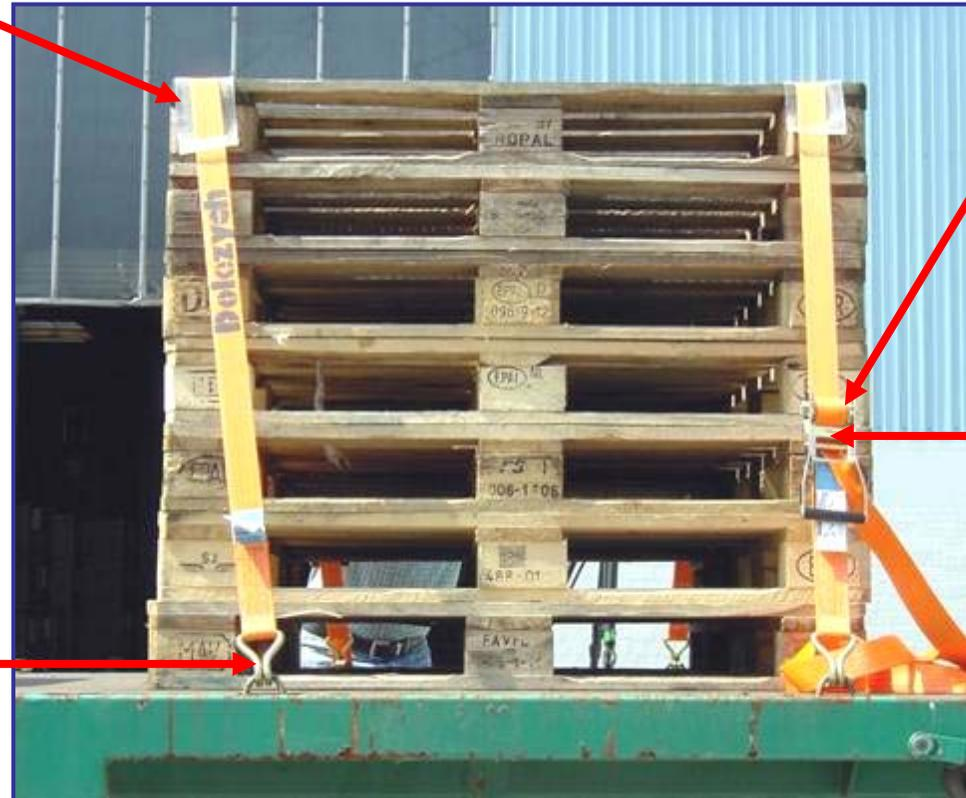
Die Zurrmittel müssen an geeigneten Zurrpunkten befestigt werden.
